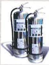
**ถังดับเพลิงชนิดฟองโฟม (FOAM)** เป็นถังอะลูมิเนียม สีครีมหรือดังสแตนเลส มีหัวฉีดเป็นฝักบัว มีน้ำยาโฟมผสมกับน้ำอัดแรงดันอยู่ข้างใน เวลาใช้แล้วดับจะดันบ้ำฟองผสมกับโฟมออกมากจากฝักบัว กระจายไปปะคลุบบริเวณไฟให้ ทำให้อับอากาศและช่วยลดความร้อน ใช้ดับไฟประเภท A และ B
